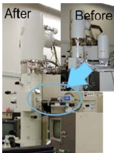
図1. Si(Li)半導体検出器(右上写真)と、導入したシリコンドリフト型検出器(写真中央円内)。
