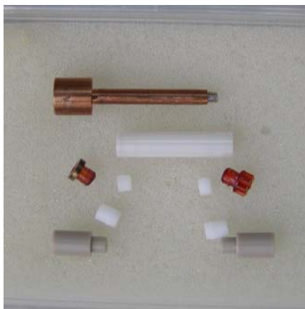
図1.今回開発した液漏れしない固体NMR試料管 従来品よりも4倍以上の高速回転にも耐えられる。
